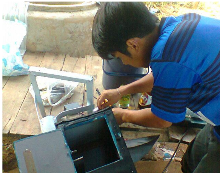
รูปที่ 3.2.4 ขั้นตอนการทำฝาเปิด-ปิดกล่องเก็บอุปกรณ์
