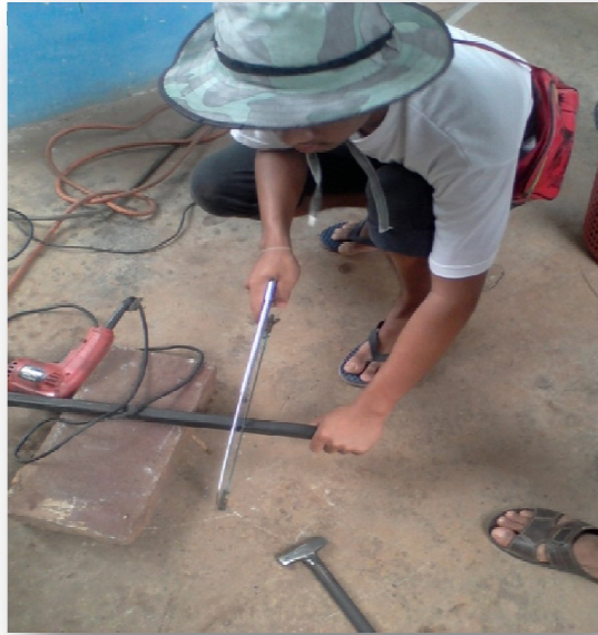
รูปที่ 3.2.1 ขั้นตอนการตัดเหล็กเพื่อทำโครงสร้าง
