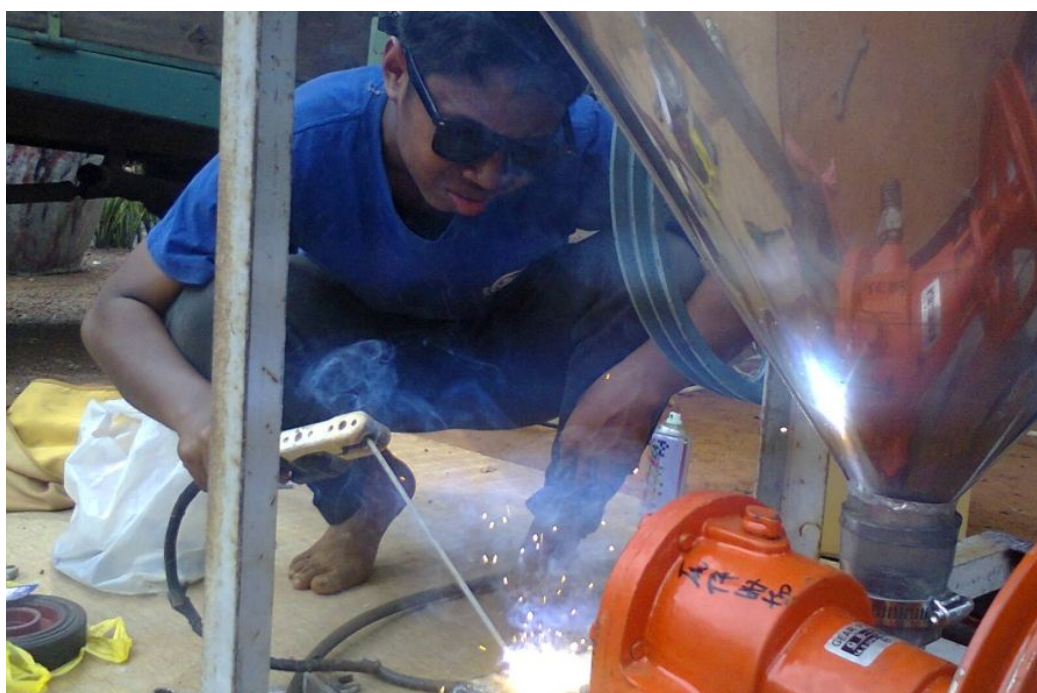
ภาพ ก - 10 การเชื่อมเหล็กวางปั๊ม
